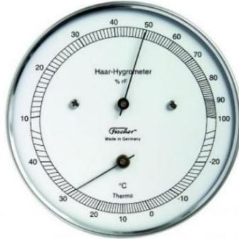
Mechanischer Klimamesser mit Echthaar-Hygrometer und mit Thermometer im Edelstahlgehäuse. Ideal für Messungen im Freien und in hoher Feuchte.
