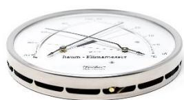
Haarhygrometer synthetic, kombiniert mit Bimetall-Thermometer zur Messung des Raumklimas.
