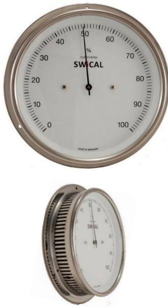
Mechanisches Hygrometer zur Messung der Raumfeuchte, mit Aufhänge-Öffnungen für die Wandmontage.
