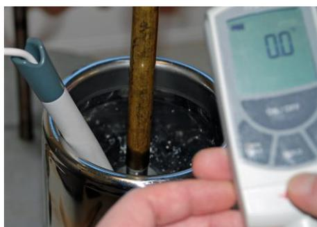
Etalonnage en bain d'une sonde de température
