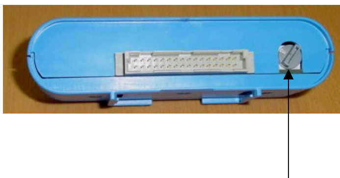
Drehschalter zur Einstellung des TC
