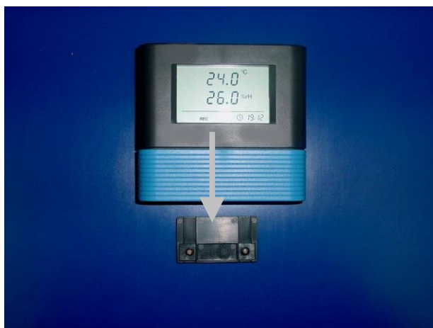
Bild: Datenlogger auf Haltewinkel schieben
