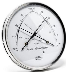
Hygromètre à cheveux synthétique, avec un thermomètre bimétallique pour la mesure de la température ambiante.
