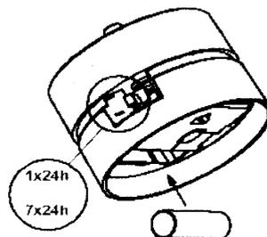
Note : la pile standard modèle CEI R6 ou LR6 assure une autonomie supérieure à 1 an à 23°C. Utiliser une pile alcaline étanche.
