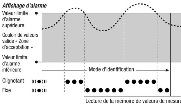
En outre, il est possible de paramétrer une hystérésis afin d'arrêter l'alarme lorsque la valeur de mesure se retrouve dans la zone valide.
