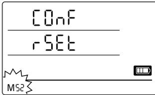
Cette fonction permet à tous les paramètres de l'appareil d'être réinitialisés sur les paramètres d'usine.
