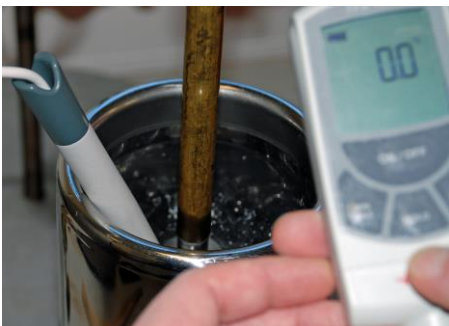
Kalibrierung einem Temperatur-Messfühler im Bad
